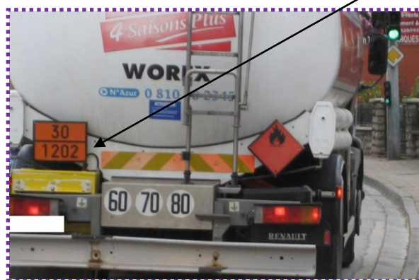
Camion-citerne transportant du gasoil
